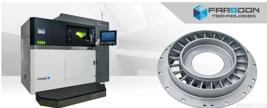
△金属连续增材制造解决方案 FS421M。采用全新的全惰性气体保护环境下的全自动闭环上送粉、清粉系统，实现余粉实时回收，即刻重复使用，极大提高粉末利用率的同时，确保了设备的安全性能。优秀的密封性，全惰性气体保护，使氧气含量控制在 100ppm 以内，其滤芯可以进行惰性气体反吹，大大延长滤芯的使用寿命，帮助客户
