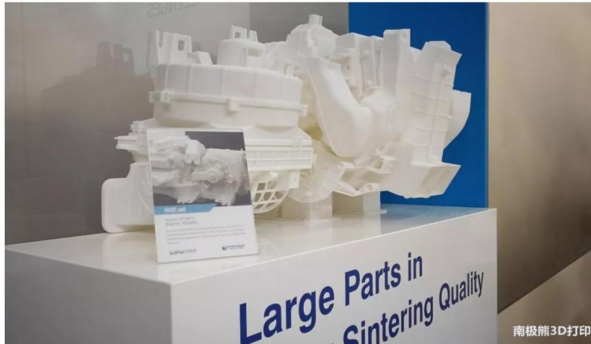
△HT1001P 系统打印的 HVAC 空调系统（一次成型，尺寸为 810\*465\*431 mm）
