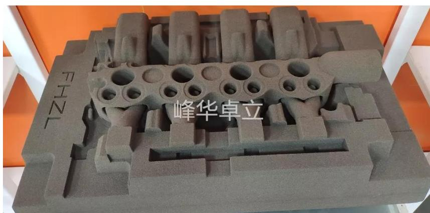
△3D 打印发动机缸盖砂型/芯
