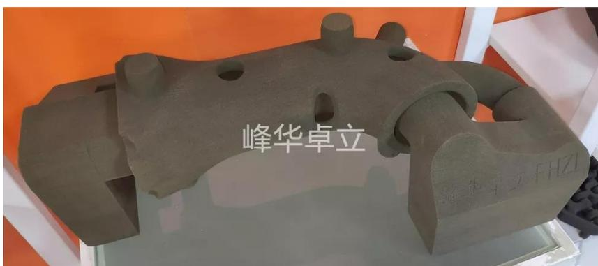
△3D 打印液冷排气管砂芯
