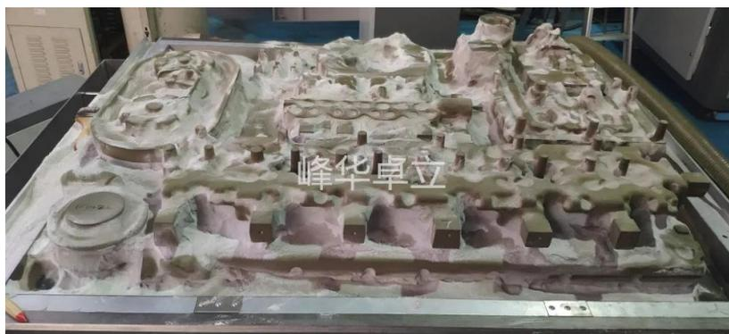
△3D 打印砂型清砂过程
